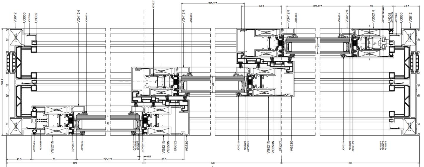
**⚠ Attention :** avec ce type de fenêtre coulissante, il n'y a pas de profils de connexion, pas de connexion d'angle à 90° ou à angle variable possible.
